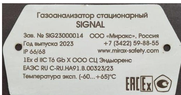
Рисунок 1 – Общий вид газоанализаторов стационарных SIGNAL с указанием места нанесения знака утверждения типа, заводского номера: А – в корпусе из окрашенного алюминия, Б – в корпусе из нержавеющей стали, В – в комплекте с электронным модулем от газоанализаторов стационарных AXIOM
